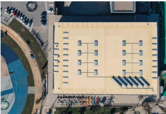
Zur Abdichtung dieses Hallendaches kam eine Dachmembran mit Solar Shield Technologie zum Einsatz, die das Material vor UV-Strahlen schützt und dadurch eine längere Lebensdauer ermöglicht. Foto: RENOLIT Ibérica
