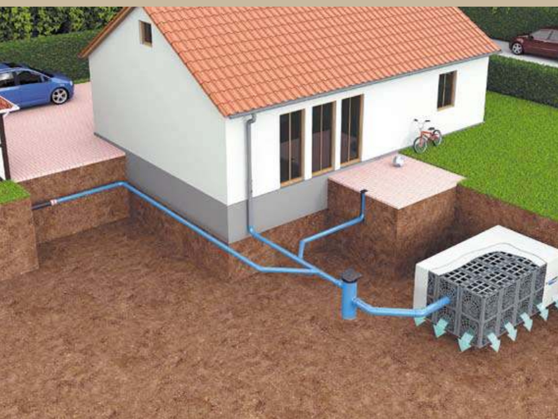
Der innovative D-Raintank kann beispielsweise für die Entwässerung von Dach und Terrasse eingesetzt werden.
